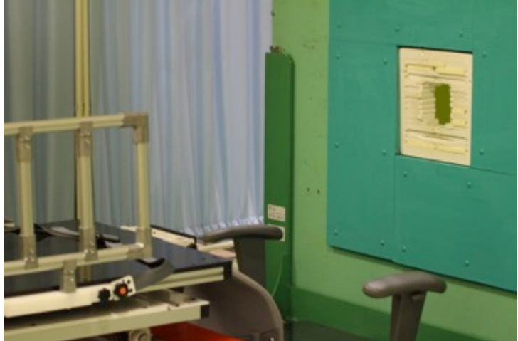
写真2. 放射線医療の装置。緑の壁のすぐ向こうが原子炉。手前のベッドに寝て、奥の穴に患部を固定し、放射線を照射する。
