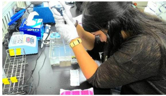
写真 2. 電気泳動用ゲルに試料を流し込む作業風景
